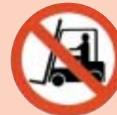
Prohibido el paso a carretillas
